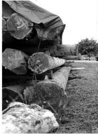
Obr. 2: Špatně! Horní vrstva nevyčnívá.
