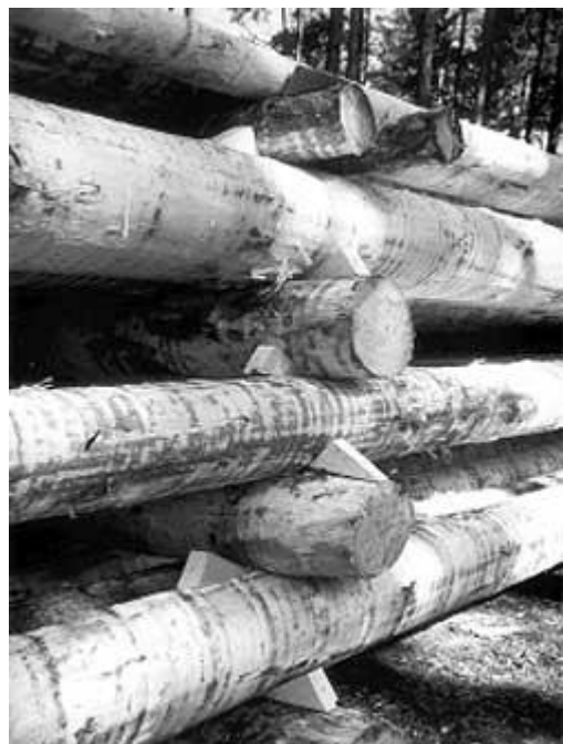
Obr. 1: Zajištění kulatiny dřevěnými klíny.
